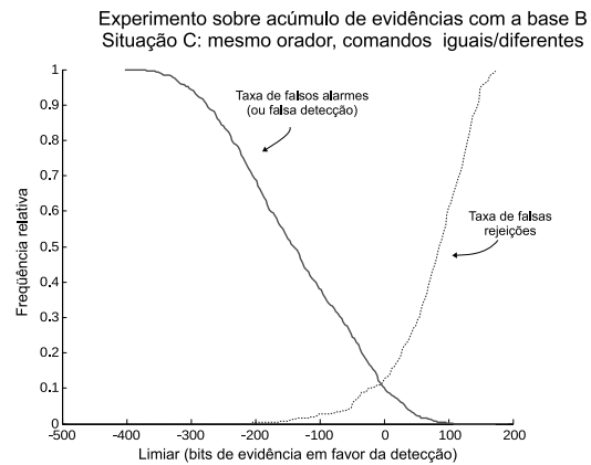
Figura 4: Ilustração da relação de compromisso entre falso alarme e falsa rejeição de comandos (situação C). Vale notar que os valores negativos de evidências em favor de H_1 , no eixo horizontal, correspondem a evidências positivas em favor de H_0 .
